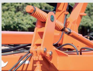
Regulagem de nivelamento para transporte através do fuso regulador. Fuso de regulagem para controle de profundidade individual dos quadros laterais.
