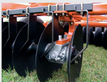
Sapata tipo "C" de fixação dos mancais, conformado para manter a profundidade de gradagem e trabalhar em qualquer tipo de solo.
