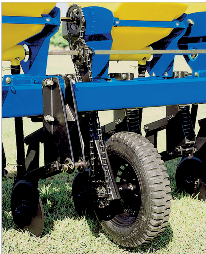
Acionamento das adubadeiras atravs de pneus militares 5.60 x 15.
