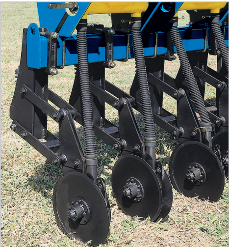
Mdulos com maior curso de flutuao e profundidade facilmente ajustvel.
