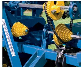
**Recâmbio:** TRA (Troca Rápida Automática) com 43 combinações no adubo. Câmbio externo para facilitar as trocas de engrenagens.
