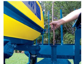
**Equipada com sistema de corte automático** das ramas, através de lâminas acionadas pelo pneu do equipamento. Tamanho aproximado do corte das manivas: 13,5 cm.
