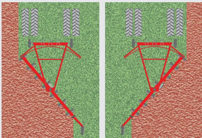
**Sistema de Reversão Horizontal:** Com apenas um conjunto de aivecas, a reversão é rápida e simples, através de um cilindro hidráulico de dupla ação.
