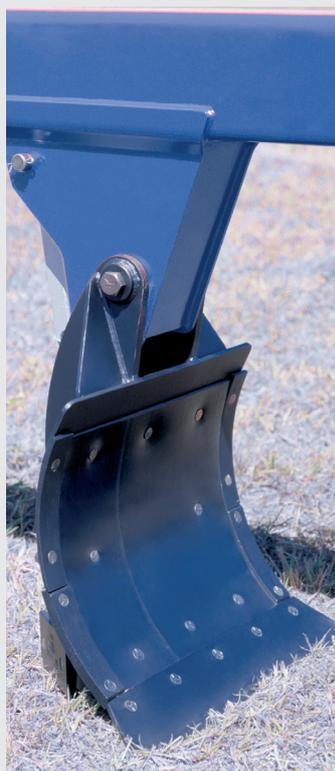
**Revestimento com Placa de Polietileno**
