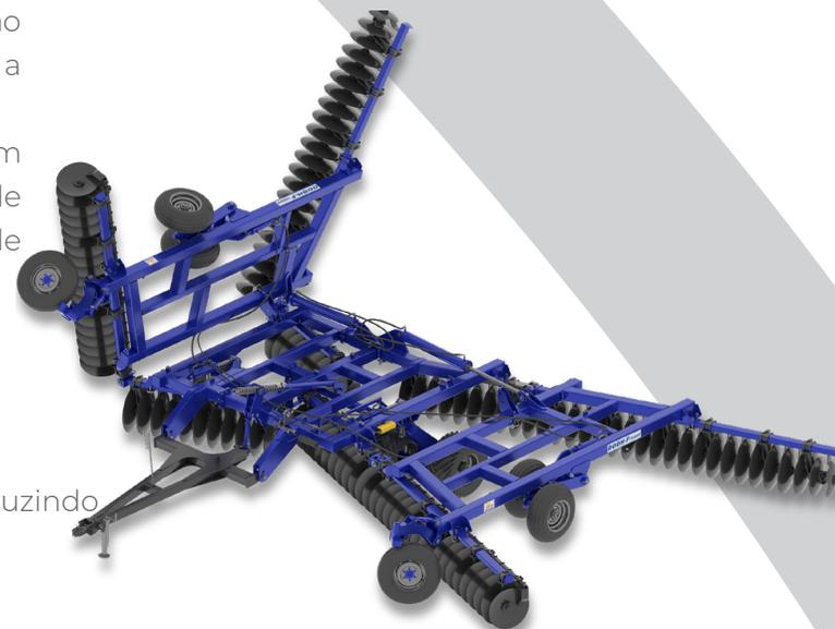
**MANCAL DUROMARK OSCILANTE® (DMO):** possui suporte de oscilação, que permite que as seções de discos girem mais livremente, reduzindo o esforço e conseqüentemente o consumo de combustível do trator, além de aumentar a durabilidade dos componentes internos do mancal e possuir encaixes que permitem a fácil montagem e desmontagem. São equipados com rolamentos de rolos cônicos e retentores Duo-Cone com lubrificação permanente a óleo.
